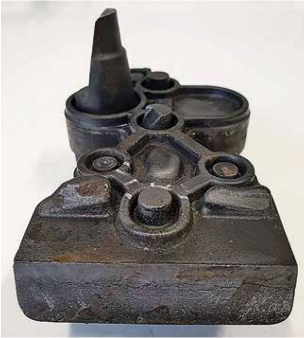
Werkzeug aus dem Aluminiumdruckguss vor (links) und nach (rechts) der Reinigung mit zwei alkalischen Reinigern/Aluminium die-casting tool before (left) and after (right) cleaning with two alkaline cleaners.
