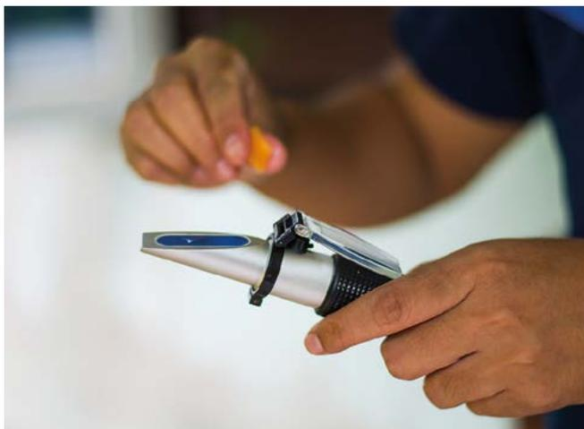
Controle das concentrações através de um refratômetro portátil
